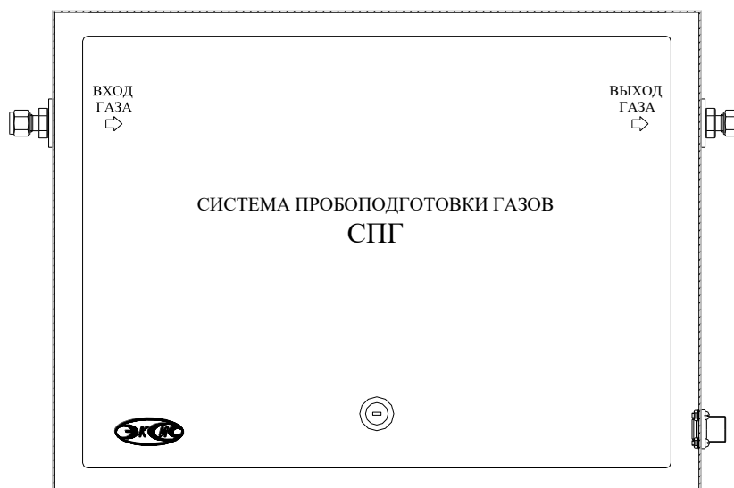
Рисунок 3.16 Внешний вид системы пробоподготовки газов
